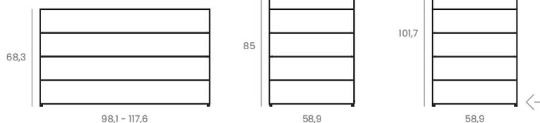
Los frontales de los cajones tienen 1 cm de espesor y están separados 1,9 cm de la estructura. De esta forma, se genera un espacio entre ambos, que permite la apertura del cajón.
