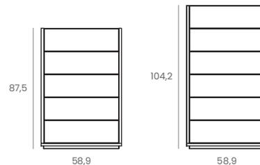
El **primer cajón se abre manualmente**, pero el resto en **sistema push**. Este sistema incorpora mecanismos que combinan bisagras y retenes sensibles a la presión que se accionan con una leve pulsación.
