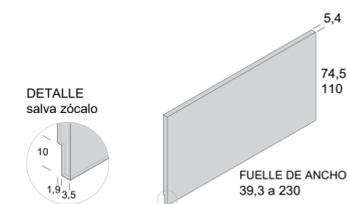
cabezal ingletado de 5,4cm con hueco interior de 3,5cm
