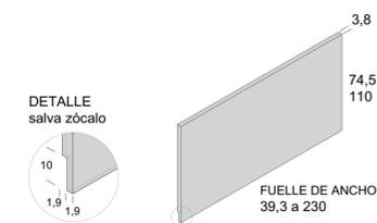
cabezal ingletado de 3,8cm con hueco interior de 1,9cm
